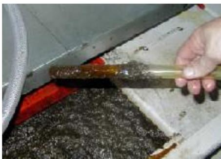
**Принцип работы скиммеров Friess** основан на адгезии (прилипанию) собираемого продукта к поверхности коллектора. В моделях WBS / BSU коллектором является бесшовная эластичная лента из специального полимера (гидрофобный и олеофильный материал). Длина коллектора зависит от модели.
